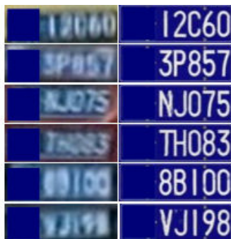
Figura 2.8: SRGAN adaptada para recuperar conteúdos de imagens de placa de automóveis. (LIU et al., 2017)
